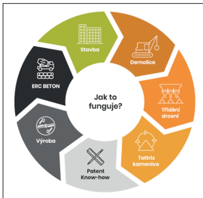
Obr. 58: Příklad principu recyklace stavebních demolic (zdroj Firma ERC BETON s.r.o.).
